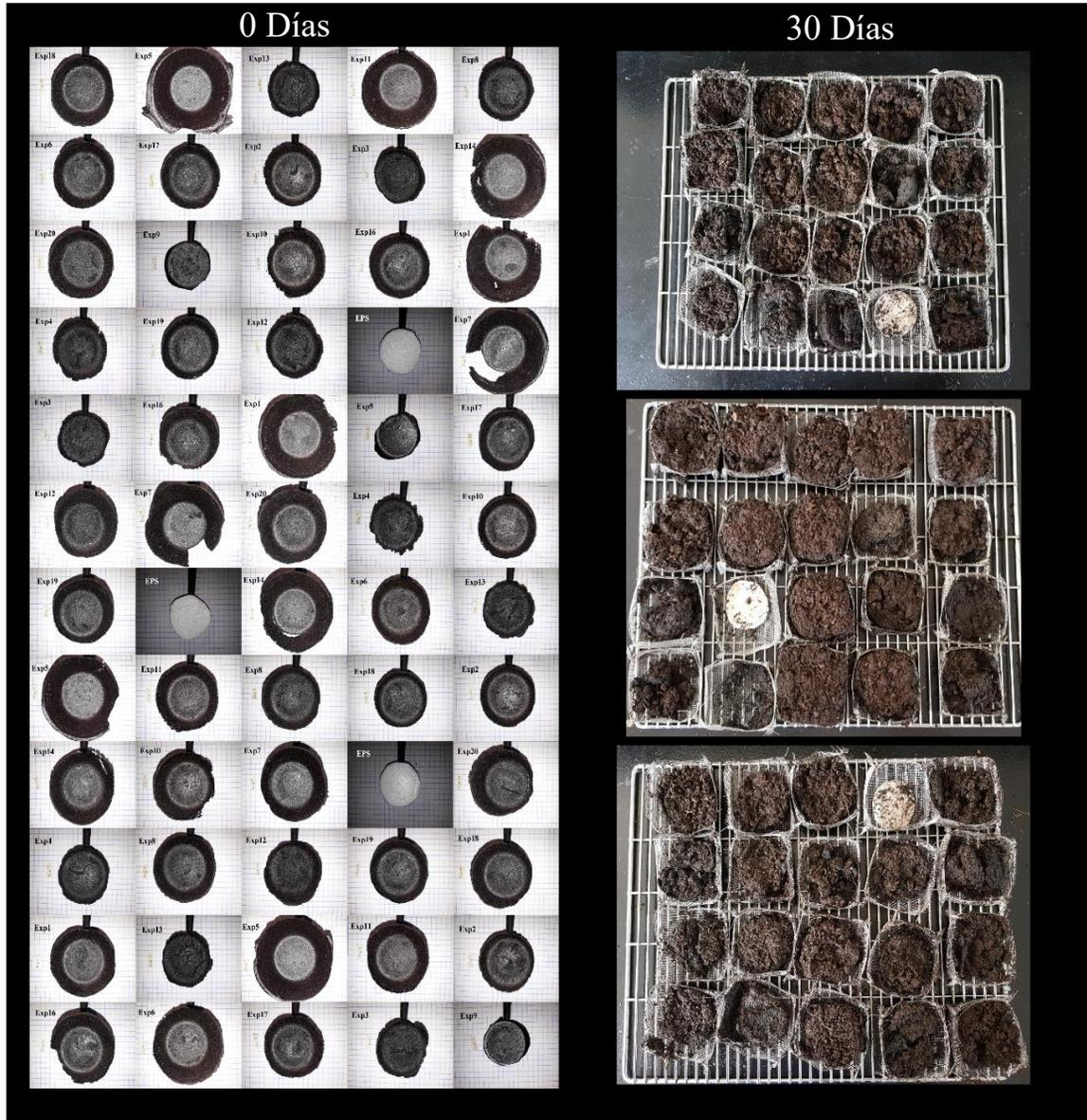
Figura 20. Efecto de la degradación en compostaje durante 0 y 30 días en los experimentales evaluados.
