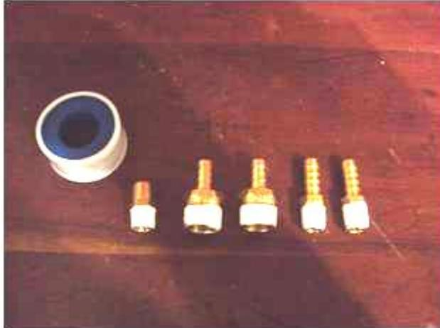
Figura 2. Adaptadores para válvula con cinta teflón.
