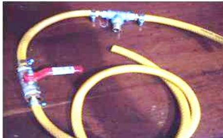
Figura 5. Mangueras para gas conectadas a la válvula y conector en T.
