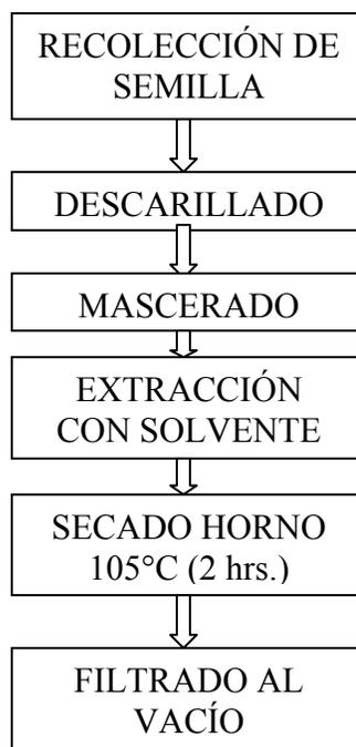
Figura 4. Diagrama de flujo de extracción de aceite de piñón e higuierilla.
