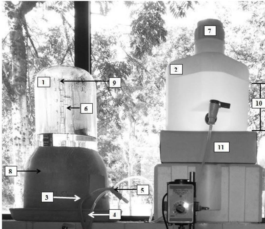
Componentes: (1) Colector de gas (9.5 L), (2) Reservorio de agua (10 L), (3) Conexión de gas desde el bioreactor, (4) Descarga del gas con abrazadera, (5) Conexión de drenaje con abrazadera, (6) Entrada de gas, (7) Tapa de ventilación, (8) Soporte de colector de gas, (9) Escala graduada; (10) Carga de presión dinámica y (11) Conexión de desplazamiento.
