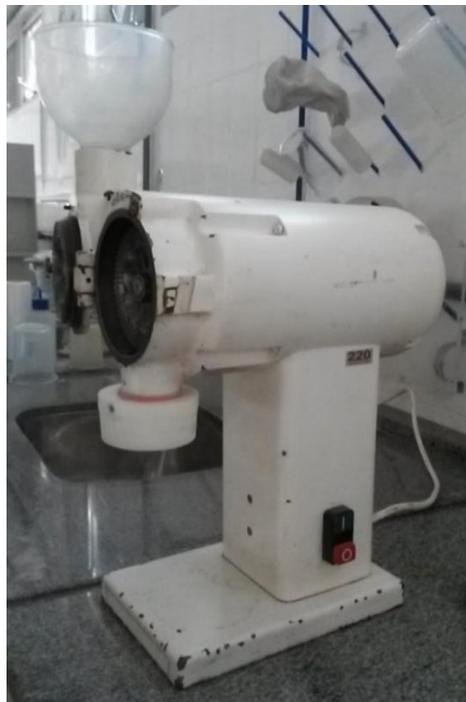
**Anexo 6.** Molino de disco de marca Laboratory Mill 3100
