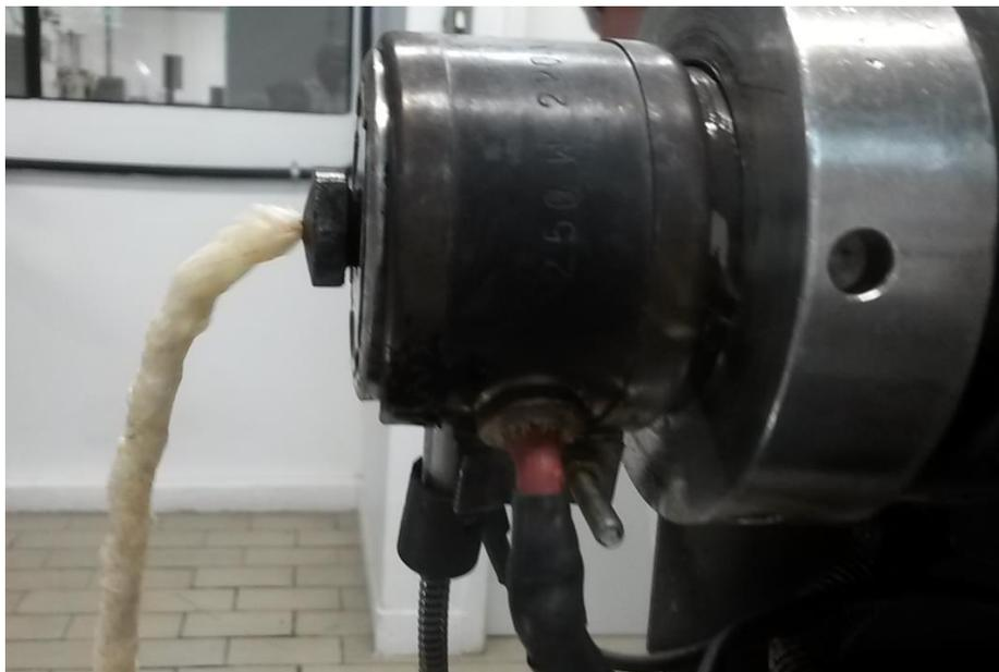
**Anexo 4.** Tratamientos listos para ser secados en horno Elka a 50°C, posteriores a la extrusión termoplástica.
