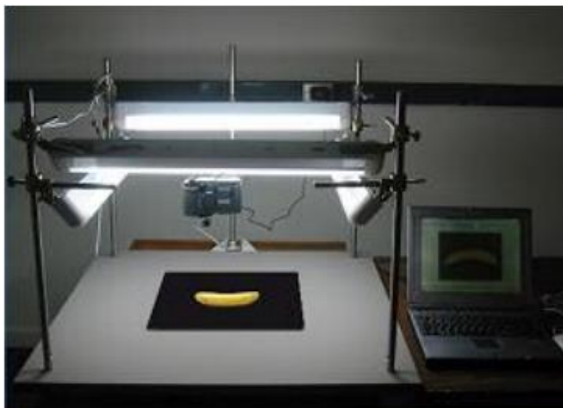
Figura 2. Ejemplo de “Computer Vision System” utilizado para evaluación de bananos. Fuente: (Mendoza y Aguilera 2004)
