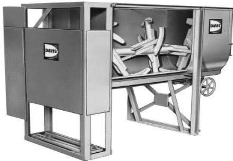
Figura 18. Mezcladora horizontal de doble listón.
