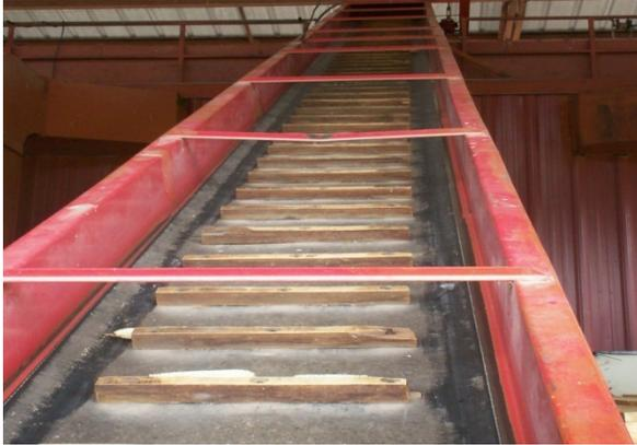
Figura 7. Transportador de mazorca K-13.
