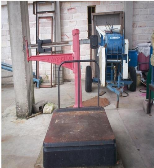
Figura 1. Balanza de metal marca AVERY.
