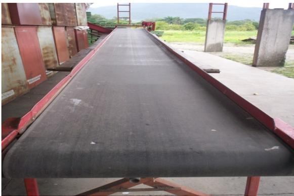
Figura 5. Transportador de mazorca K-12.
