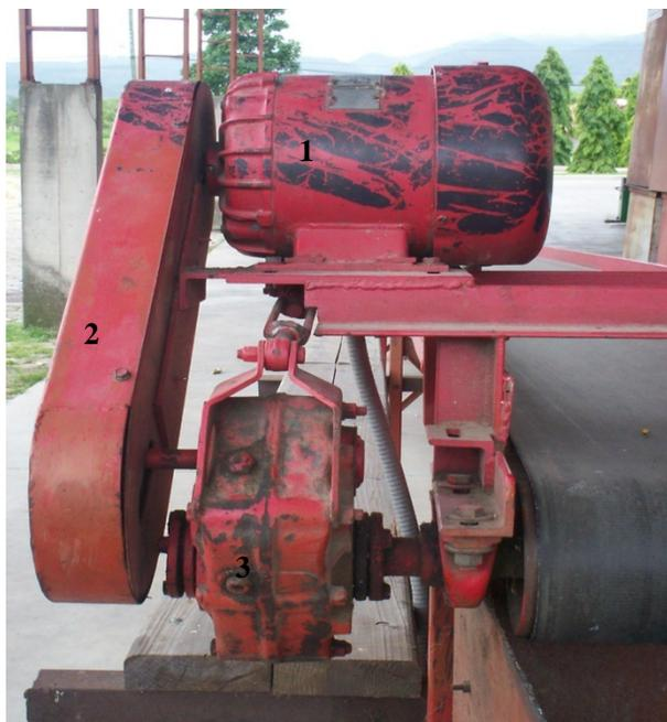
Figura 14. Sistema motor- reductor. (1) Motor “Century” Mod. SC-184-kMAEMI6-302132-03, Hz: 60, HP: 2, Volt: 220/440, Amp: 5.8/2.9, RPM: 1725. (2) Banda B-48. (3) Reductor “Dodge” VK. Tamaño: TDT215, serie: 242130, patente: 197, #: 7.67, reducción: 14.97:1, velocidad máxima de entrada: 2096 RPM.
