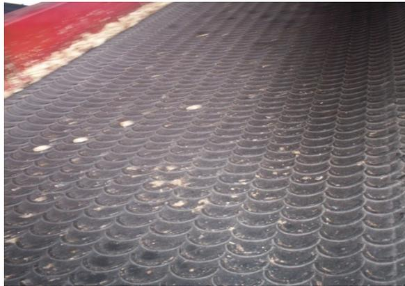
Figura 9. Banda transportadora escamada.
