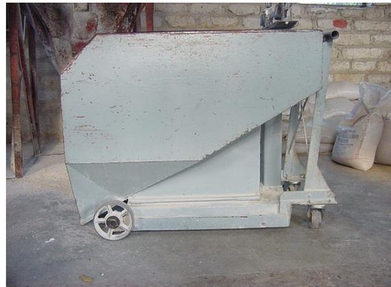
Figura 3: Balanza con ruedas.
