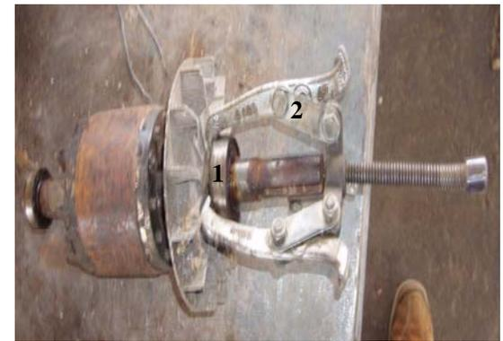
Figura 11. Balinera (1) y Puller (2).
