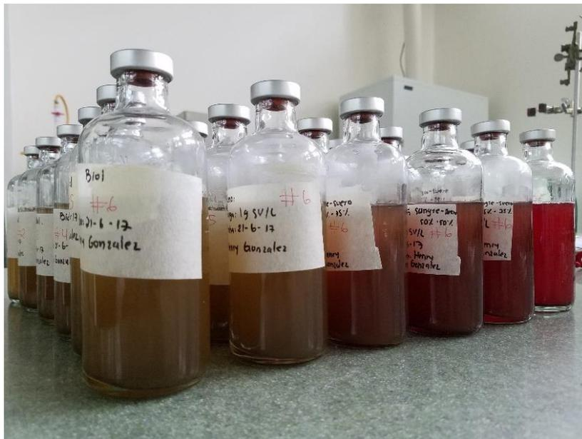
Figura 3. Reactores batch alimentados con aguas rojas y suero a distintas proporciones y una carga orgánica de 1 g SV/L.
