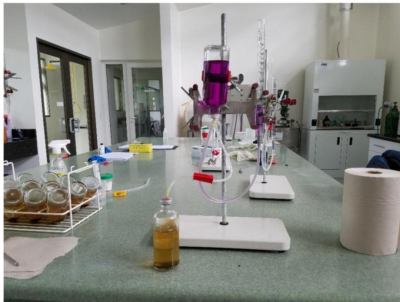
Figura 4. Cuantificación de CH<sub>4</sub> por volumetría de KOH.
