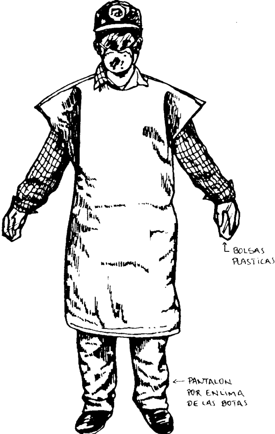
Equipo de Protección Terminado
