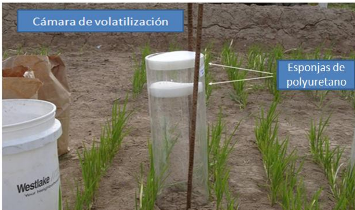
Figura 1. Inserción de las esponjas en las cámaras de volatilización 1
