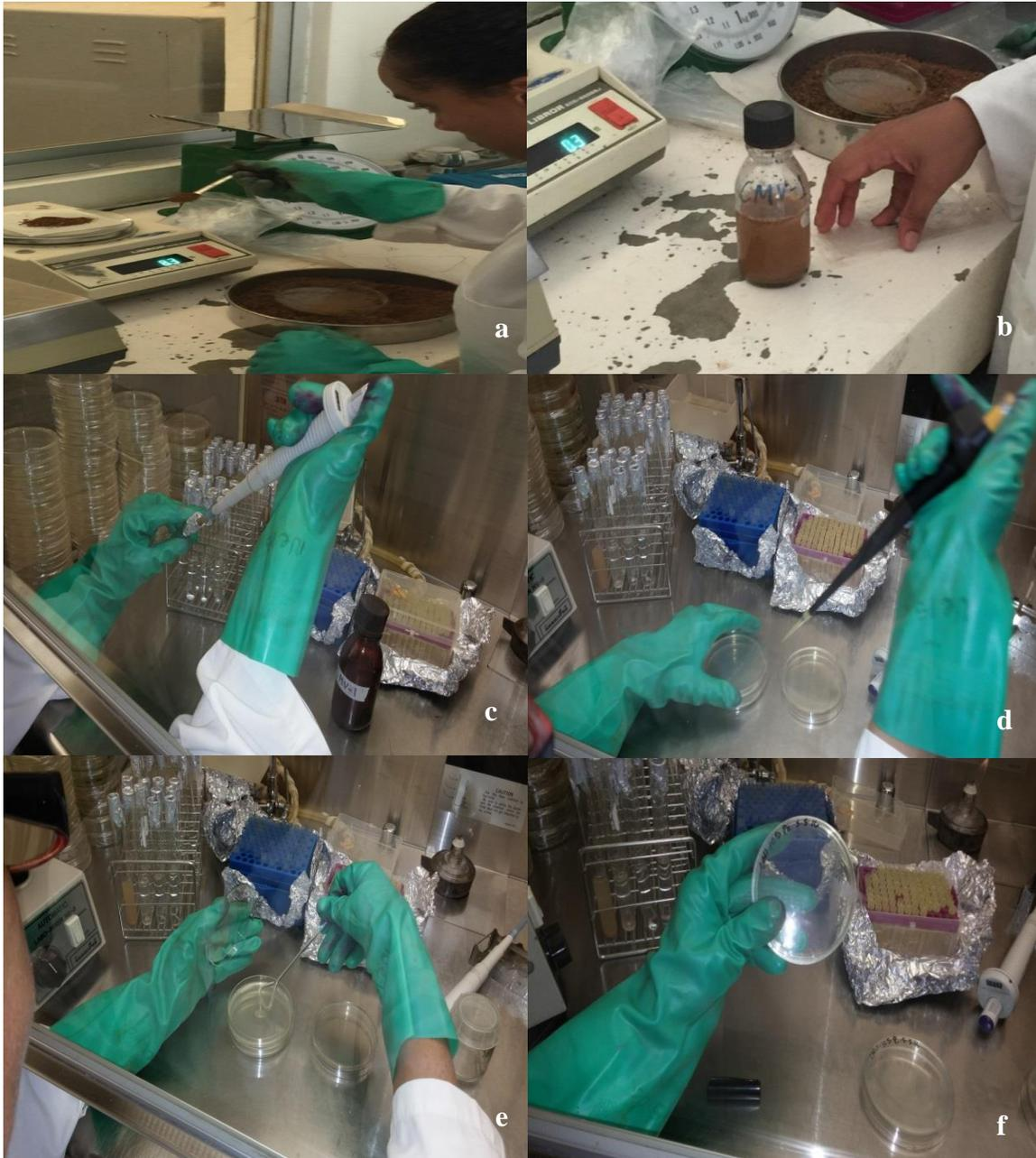
Figura 6. Procesamiento de muestras para los análisis microbiológicos. : a) Pesado de 10 g. de muestra, b) Muestra agitada en agua destilada, c) Alícuota de dilución madre, d) Inoculación de muestra, e) Esparcimiento de la muestra, f) Rotulado de muestras.
