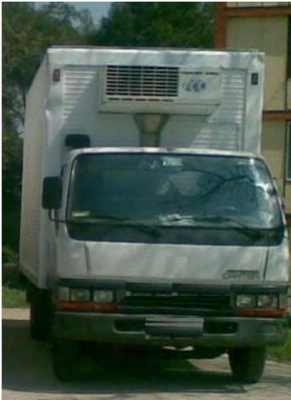
Camión Toyota con furgón refrigerado con capacidad de 4,000 Kg., furgón con equipo de frío VM 800, sistema Stand-By.
