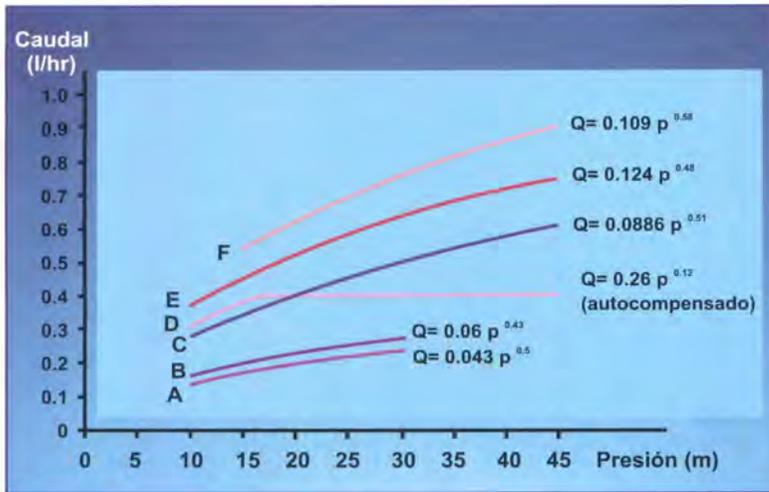
Fig. 36. Relaciones típicas de descarga y presión para microaspersión
