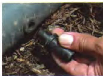
Foto 98. Conector Inicial de tubo a polietileno.
