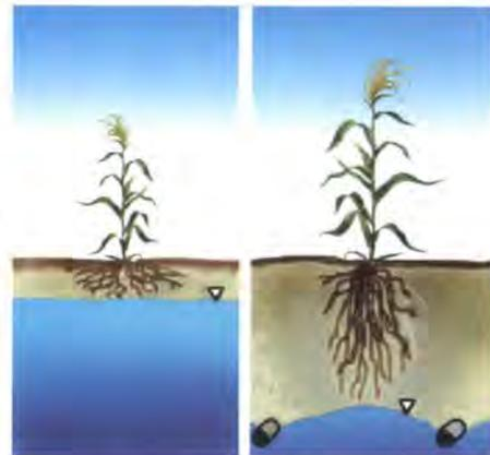
Fig. 37. Suelo sin drenaje y otro con drenaje.
