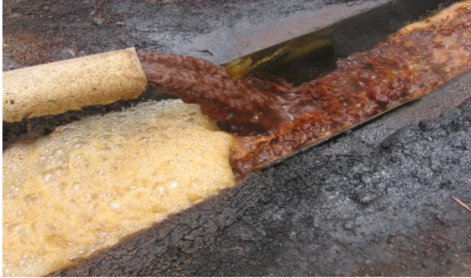
Figura 2. Efluente de vinaza proveniente del fondo de la columna de destilación, Guatemala.
