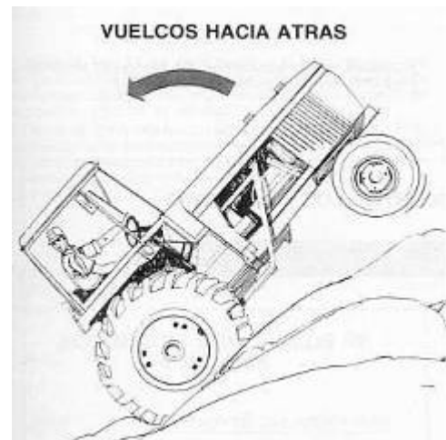
Figura 37: Vuelco hacia atrás
