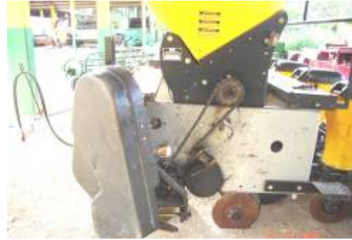
Figura 35: Escudo protector retirado por reparación
