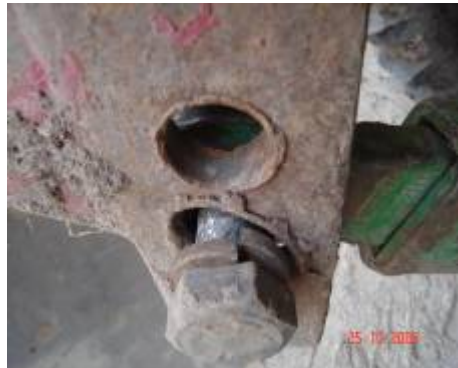
Figura 33: Acople a brazo hidráulico del tractor deforme
