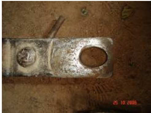
Figura 34: Barra de tiro con agujero deforme
