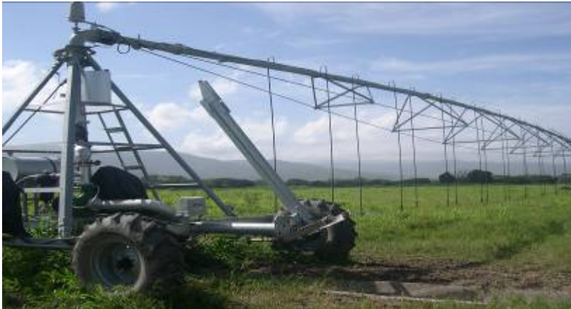
Figura 3. Sistema de Avance Frontal, Zamorano. Foto: Alba A. Lara
