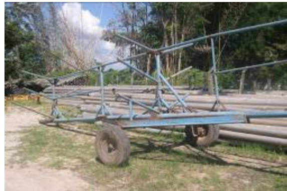
Figura 7. Equipo de aspersión portátil, Zamorano. Foto: Alba A. Lara
