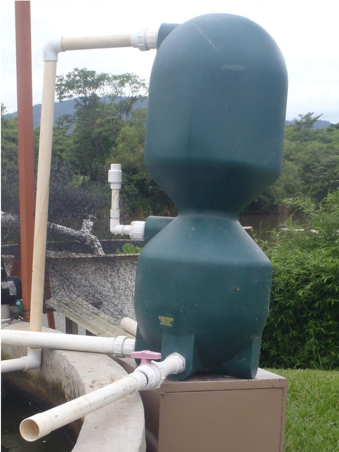
Anexo 4. Imagen del filtro de bolas utilizado en la producción de lechuga acuapónica. Zamorano, 2010.
