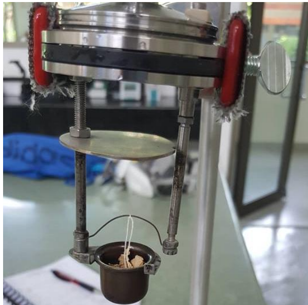
Figura 4. Preparación de muestra de biomasa en crisol para análisis en calorímetro.
