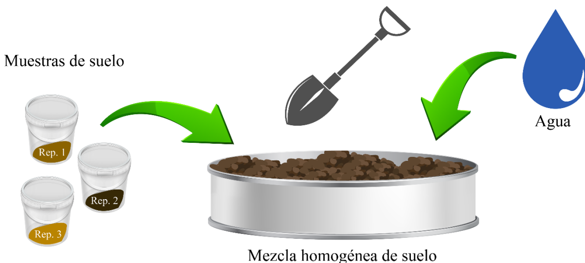
Figura 5. Procedimiento de adición y mezcla de agua a muestras de suelo.
