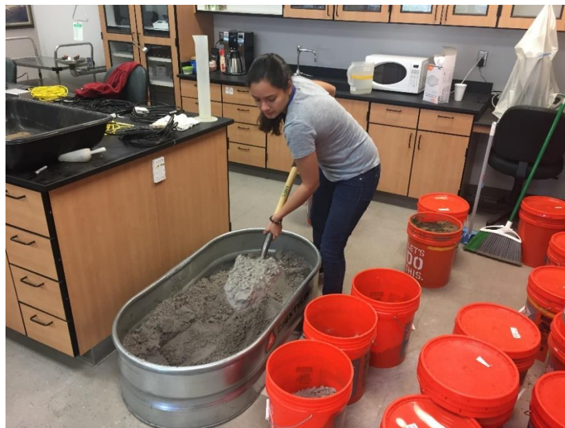
Anexo 4. Foto del método y materiales utilizados para el incrementar y homogenizar el contenido de humedad en las muestras de suelo.
