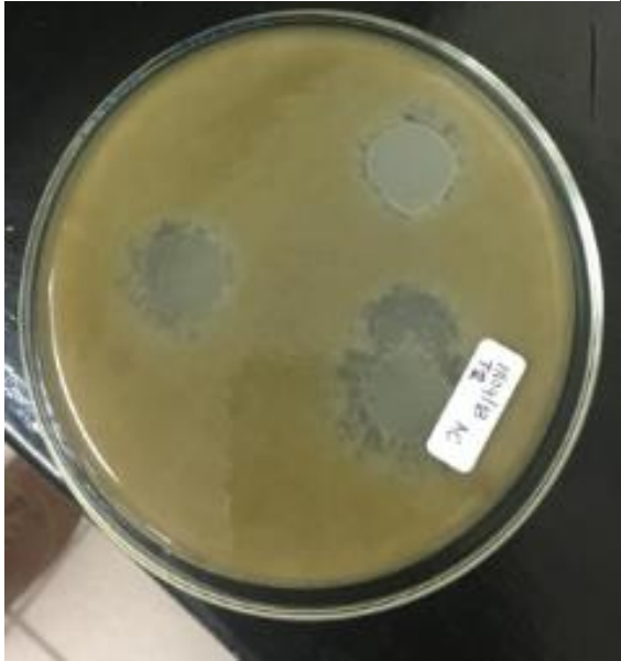
Anexo 3. Zona de inhibición de bioplásticos con diferentes concentraciones de orégano.
