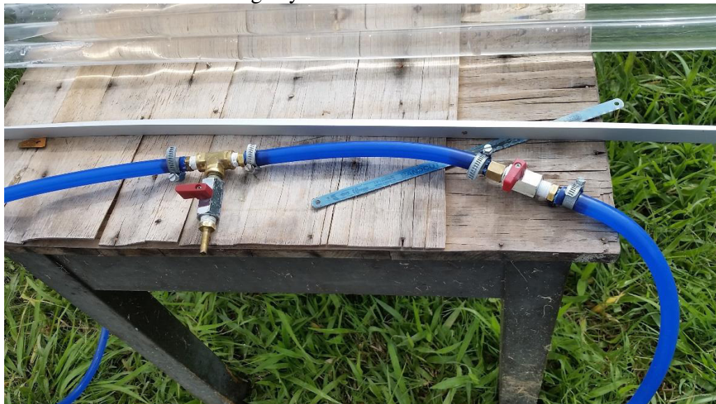
Anexo 3. Válvula de entrada de agua y de muestreo.
