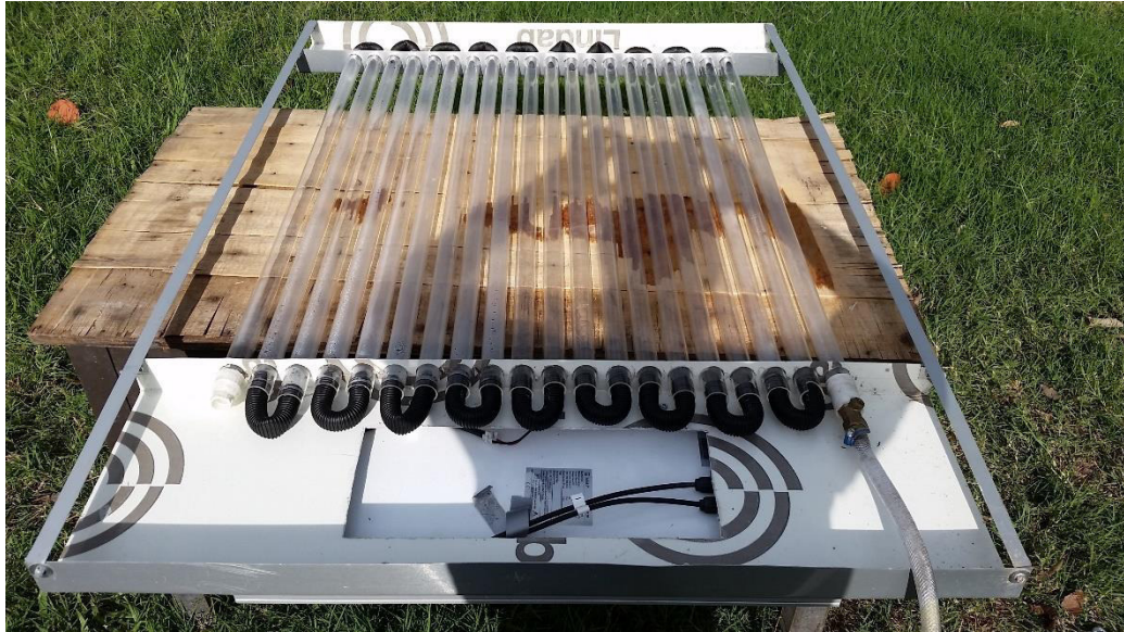
Anexo 2. Módulo de desinfección ensamblado.
