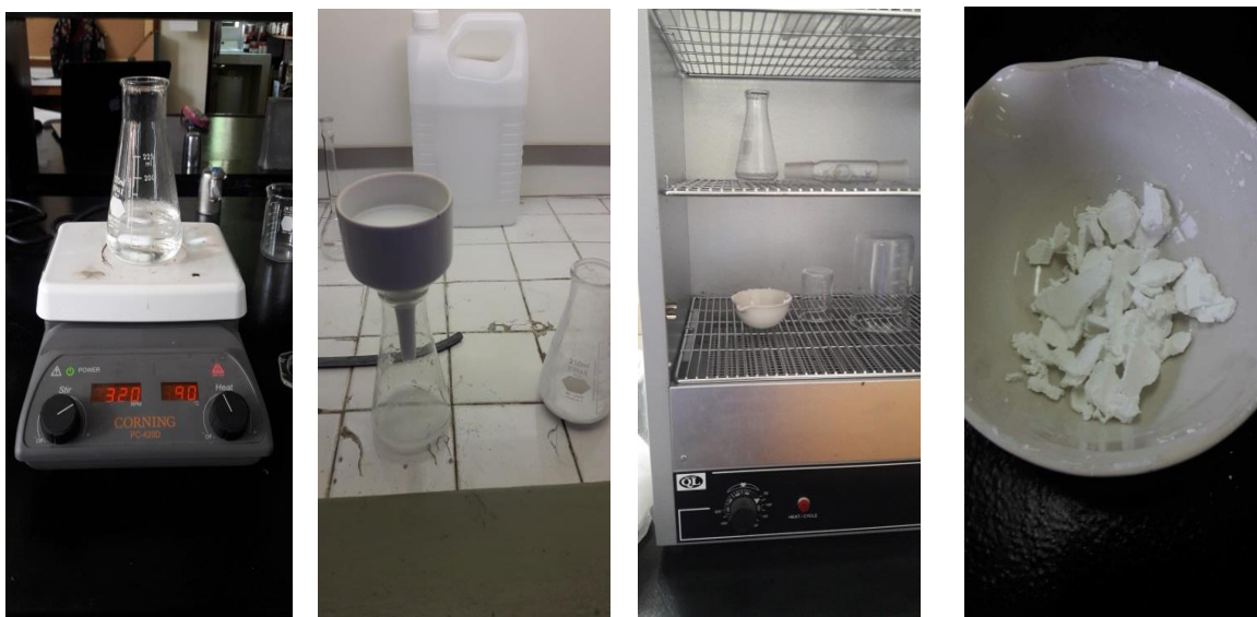
Figura 4. Fases del proceso para la obtención de Óxido de Cinc.
