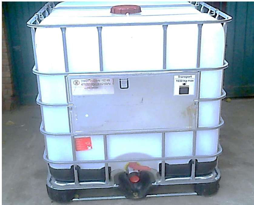
Figura 1. Biodigestor de 1000 L de capacidad, utilizado para la fermentación del biofermento de harinas, Puembo, Ecuador.
