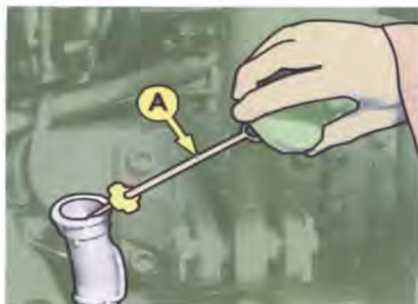
Fig. 22. Varilla para medir nivel de aceite hidráulico/transmisión.
