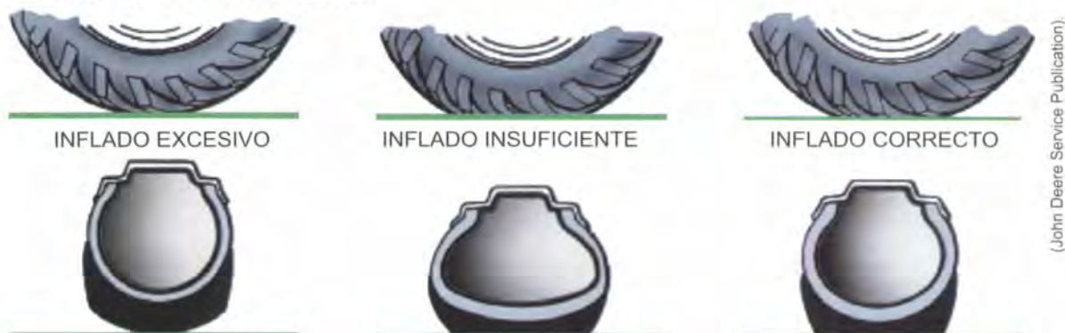
Fig. 24. Inflado excesivo: Desgaste rápido del centro de la banda de rodadura que quita flexibilidad a los neumáticos. Inflado insuficiente: Excesiva flexión de las paredes laterales originando sobrecalentamiento. Ambos dañan los neumáticos.
