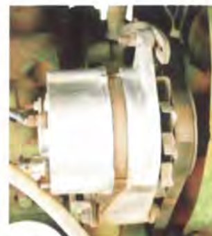
Foto 24. Tensión correa del ventilador.
