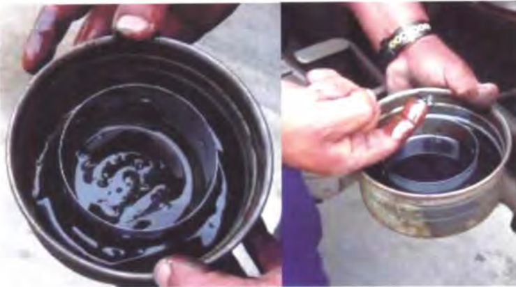
Foto 18. Base de filtro con baño de aceite.
