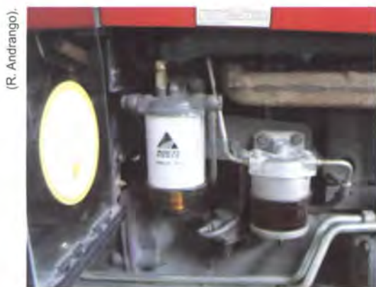
Foto 27. Filtros de combustible.
