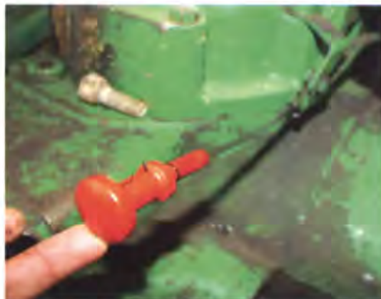
Foto 22. Varilla para medir nivel de aceite hidráulico.
