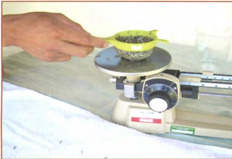
Figura 23. Conteo de alevines de tilapia por el método gravimétrico. Se determina el peso promedio de los alevines con una balanza de precisión para luego solamente pesarlos en bulto o grupos para estimar el número en una transferencia.
