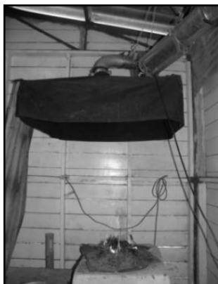
Figura 2. Quema de pasto para obtener las emisiones usando el sistema PEMS.
