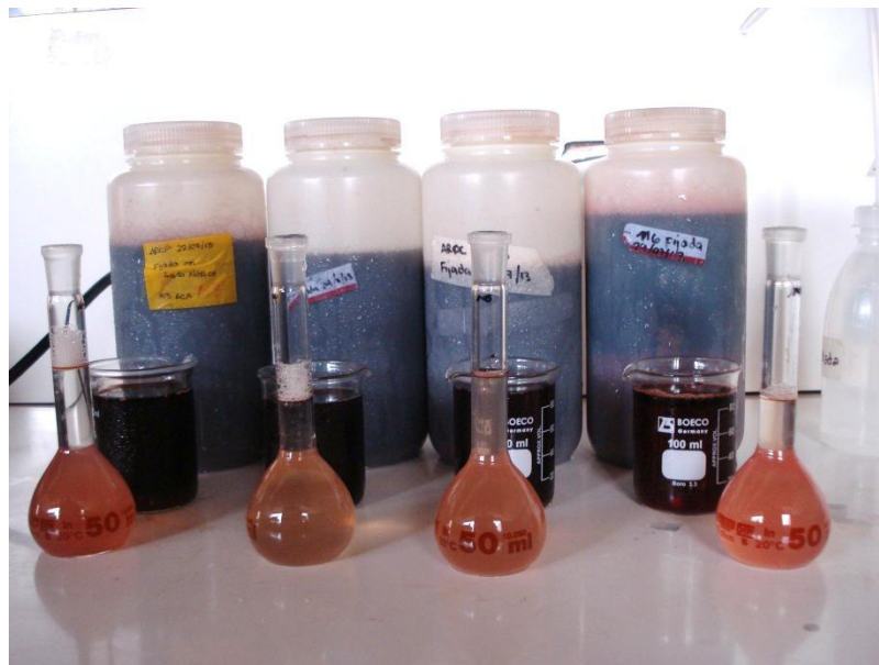
Anexo 4. Muestras y diluciones para los análisis de nitrógeno y DQO de las aguas rojas.
