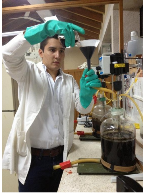
Anexo 1. Alimentación del reactor semicontinuo con la carga previamente definida por los sólidos volátiles de los análisis de las aguas rojas.
