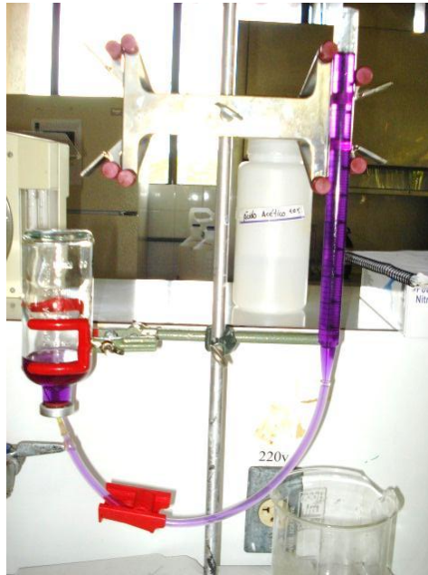
Figura 2. Esquema de medición de metano. Fuente: Elaboración propia.
