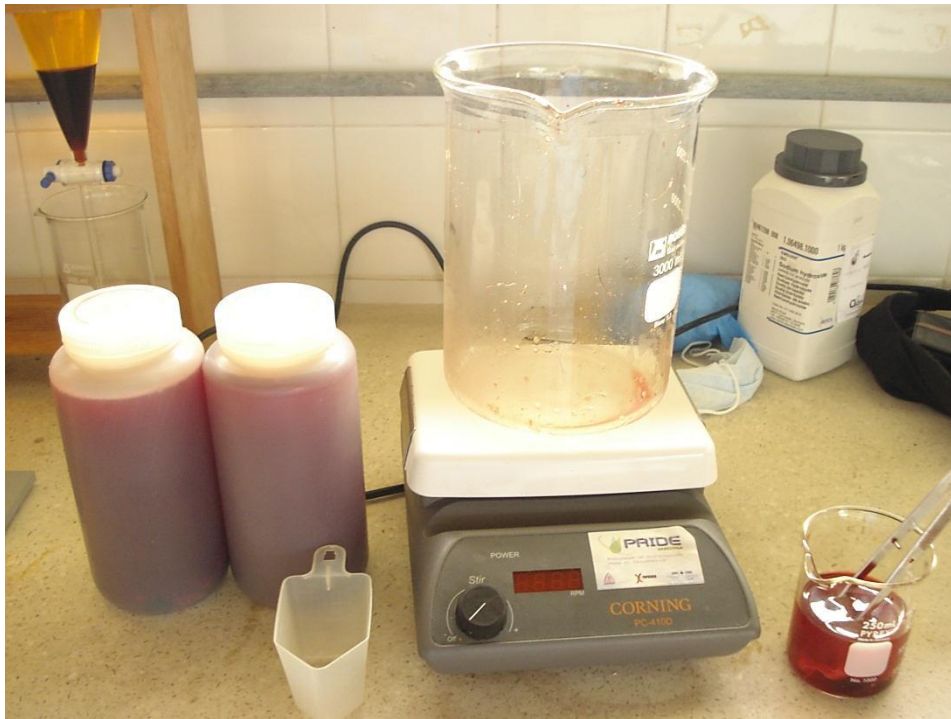
Anexo 3. Instrumentos para la homogenización de muestras de aguas rojas.
