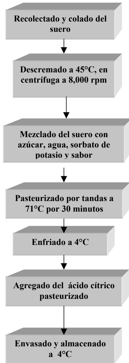
Figura 1. Proceso para la fabricación de las bebidas refrescantes a partir de suero de queso.
