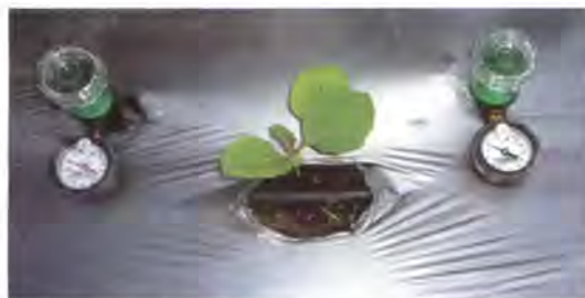
Foto 12. Tensiómetros colocados a distinta profundidad
