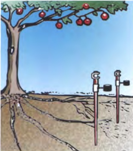
Fig. 13. Ubicación de tensiómetros en el suelo.
